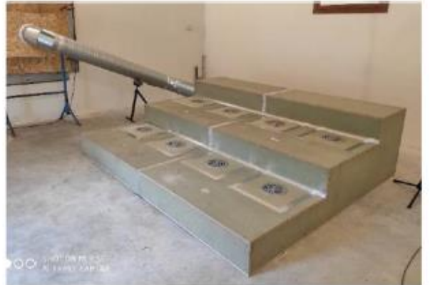
Рисунок 2 Модель трибуны с 8 диффузорами
