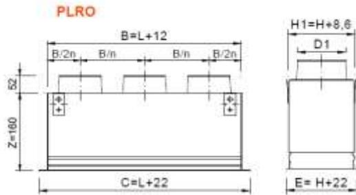
**PLRO** Пленум-бокс с верхним подключением к воздуховоду, изготовлен из оцинкованной стали. Подходит как для настенного, так и для потолочного монтажа.
