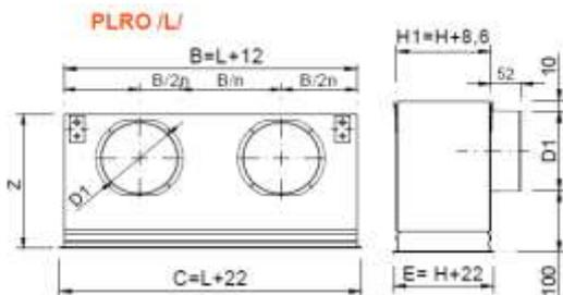
.../AIS/ Пленум-бокс с термоизоляцией из пеноматериала.
