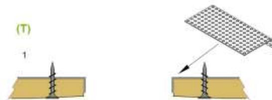
**(T)** Комплект уголков для фронтального крепления диффузора, с пленум-боксом или без него, с помощью потайных винтов.
